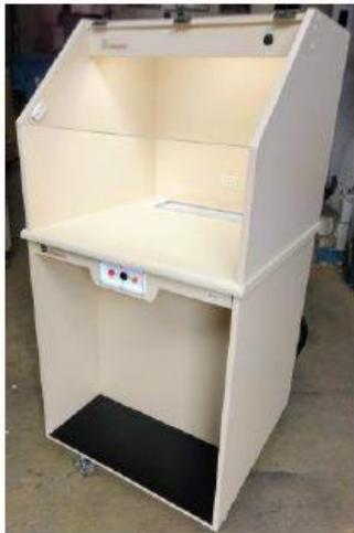
Cabine de madeira móvel para recolhimento de sujidades de livros e documentos por meio de sucção, com sistema de filtragem de ar, evitando que as partículas de sujeira retornem a ambiente. Painel frontal com interruptores liga/desliga para lâmpada fluorescente. Reservatório de água e indicadores eletrônicos para controle do nível de água do filtro. Motor 110V/50W. Locomoção através de rodízios com freio.
